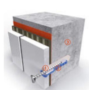
BILD S – Infästning i betongvägg
