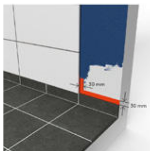
BILD M – Anslutning till målat tätskiktssystem
